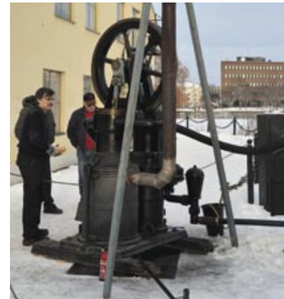
Museets varmluftsmaskin stod ursprungligen längs inlandsbanan och pumpade vatten till ångloken. Tillverkad 1908 i Eilenburg i Tyskland.
