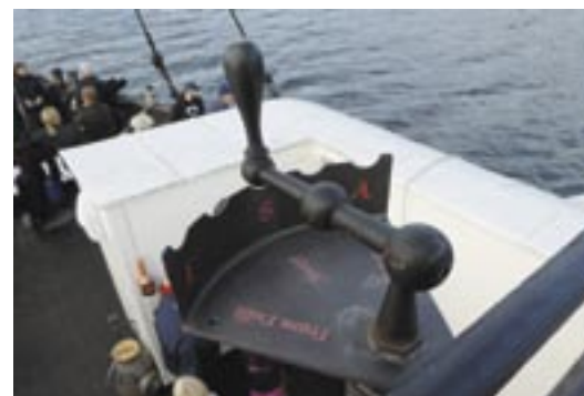
Maskintelegrafen på bryggan mellan hjulhusen.
